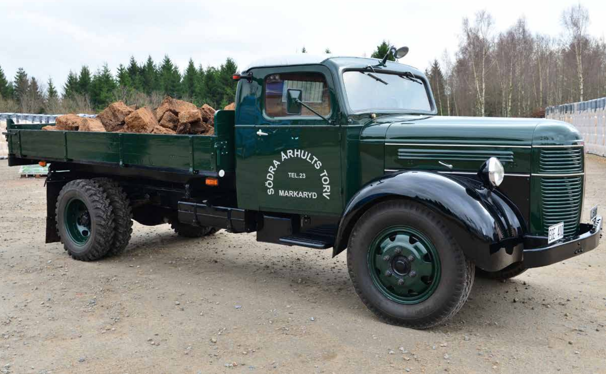
Volvo "Rundnos" 142 D årsmodell 1946. 6 cylindrig med enkel förgasare.
